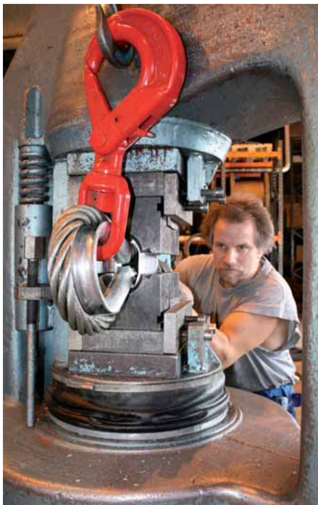
Riggeransvarlig, Owe Molund, i ferd med å produsere en forløper. Både pressen og låsene er av merket TALURIT, og levert av Talurit AB i Sverige.
