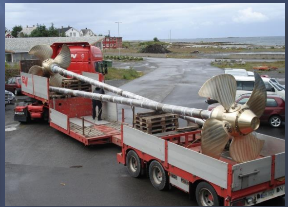
CP propeller P85, Ø2900 mm
