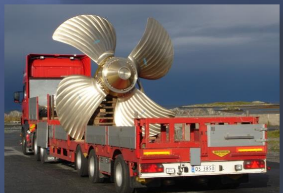
CP propeller P105, Ø4000 mm
