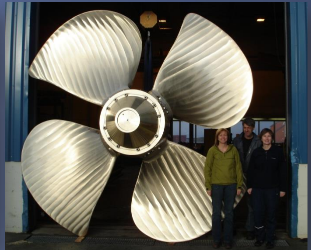
CP propeller P105, Ø4000
