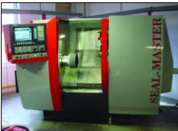
CNC-styrt maskineringscenter med speial program for pakninger.
